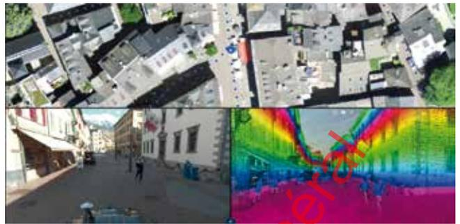
Cet outil combine un nuage de points obtenu à l'aide d'un scanner mobile et d'images géo-référencées. Il permet entre autre la mesure d'éléments avec une très grande précision directement sur l'application.
