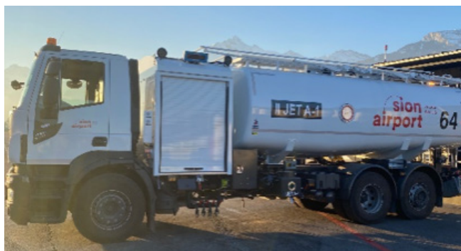
Figure 5 Nouveau camion transportant 20'000lt de kérosène
