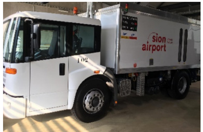
Figure 4 camion de dégivrage avion
